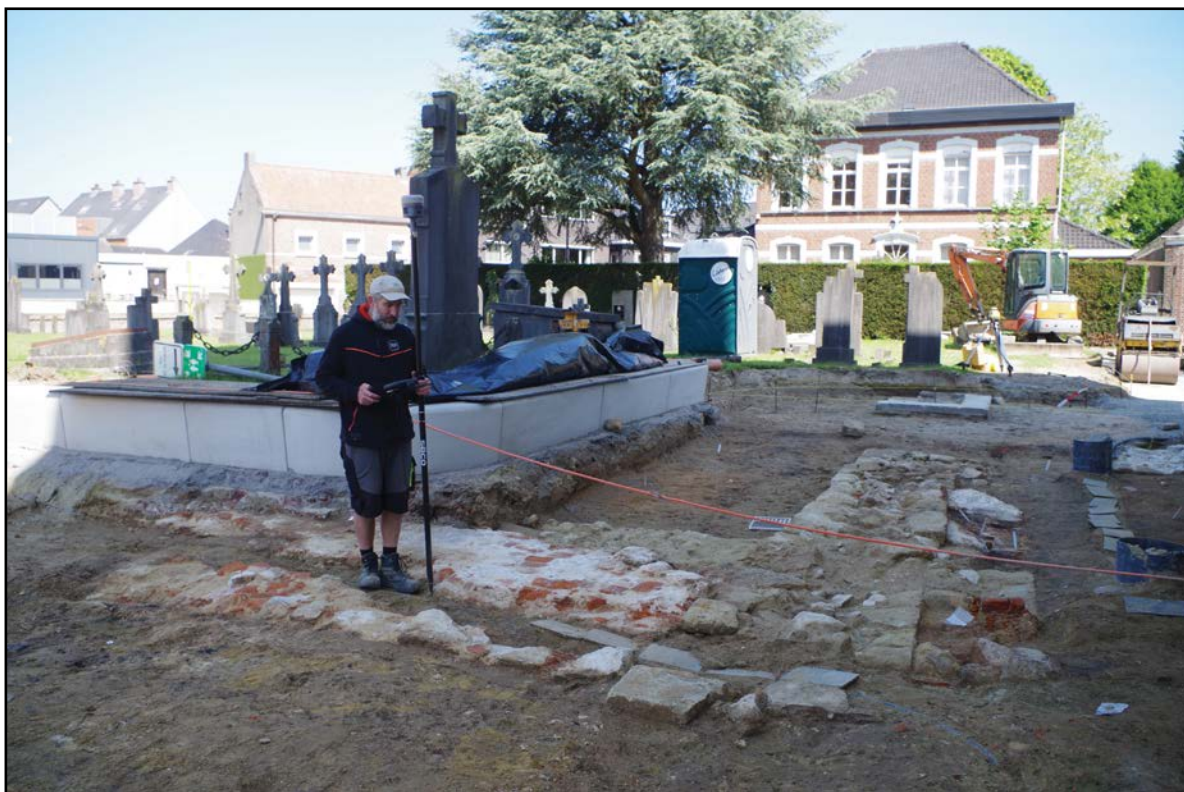
Fig. 17. Digitaal inmeten met RTS.
