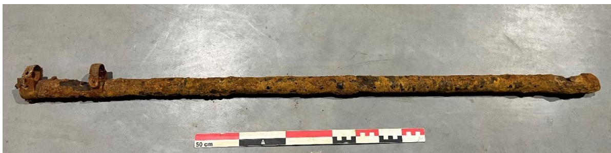
Figuur 50: Periscoop voor de 2 inch Medium Trench Mortar, aangetroffen in de kist (V039).
