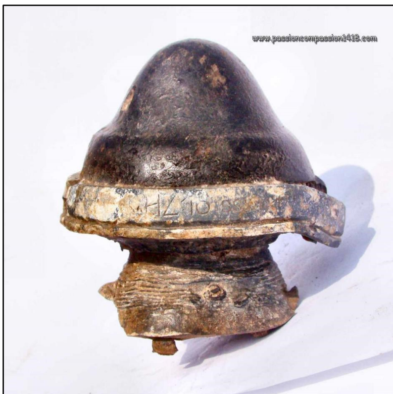
Figuur 82: Voorbeeld van een Duitse ontsteker H.Z. model 1916 ( www.passioncompassion1418.com )
