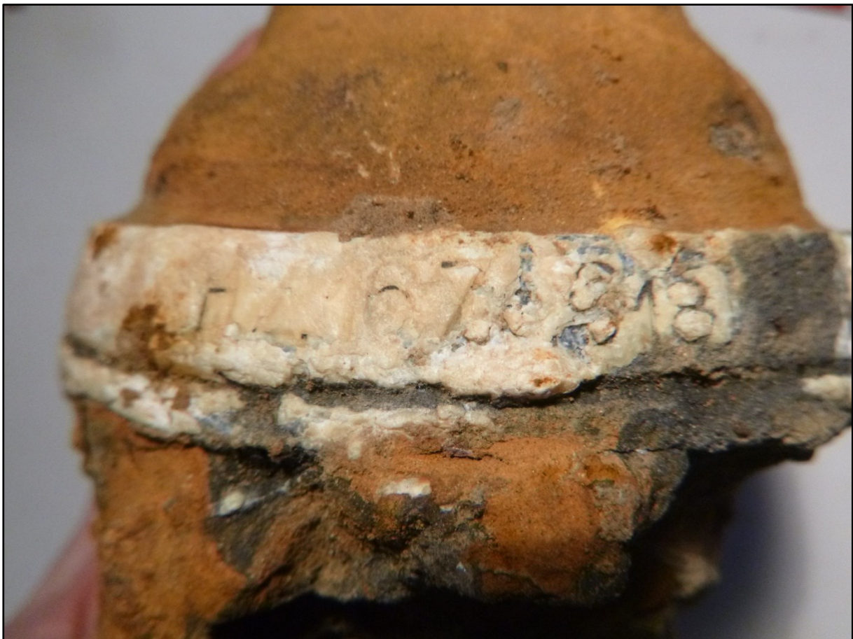
Figuur 81: Fragment Duitse H.Z. 16 ontsteker (ABO nv 2021)
