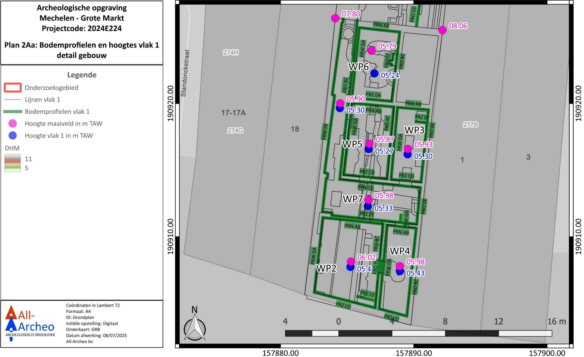
Figuur 18: Plan met aanduiding van de bodemprofielen en hoogtes van vlak 1 (blauw) en het maaiveld (magenta) in m TAW, detail gebouw, weergegeven op het GRB ( www.geopunt.be )
