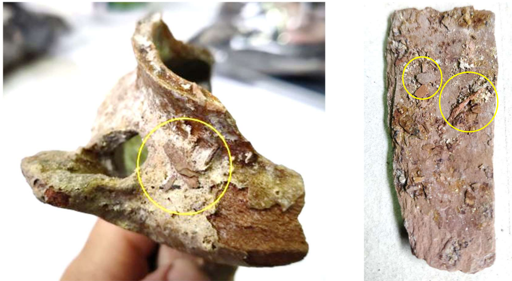
Figuur 33. Olielamp (links) en leistenen latje (rechts) met misbakken loodglazuur met daarin versmolten aardewerk en leisteenfragmentjes.
