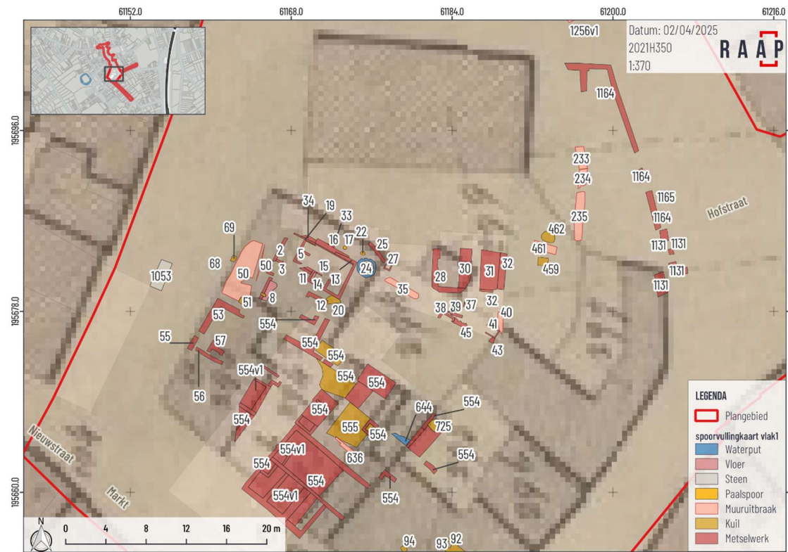
Figuur 48. Projectie van de funderingsresten en uitbraaksporen op de stadsontwikkelingskaart van 1854, gebaseerd op het primitief kadaster van 1834 (bron: KBR & AGIV, 2010).
