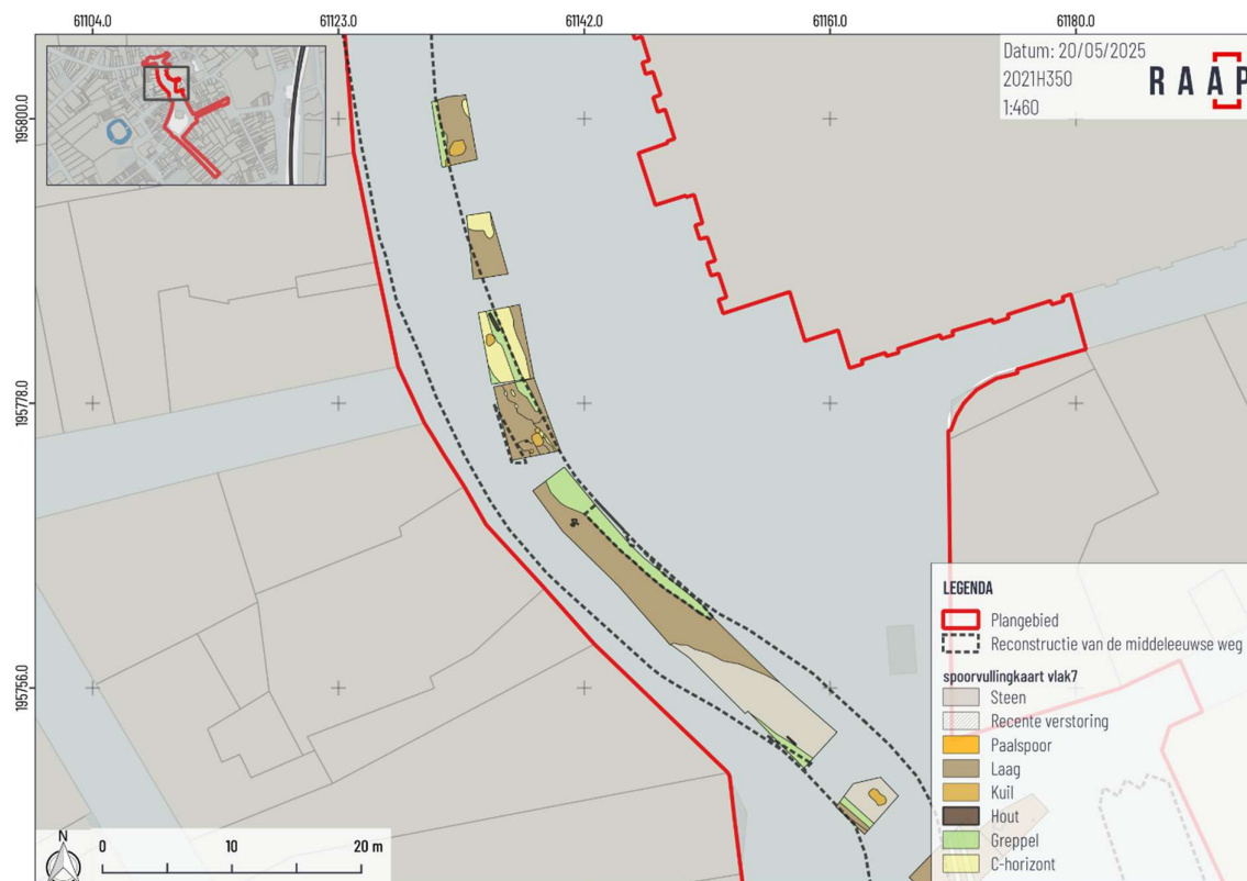
Figuur 44. Reconstructie van de weg ter hoogte van de kerk op basis van de aanwezigheid van de verharde straatniveaus en grachten die er zijn aangetroffen.
