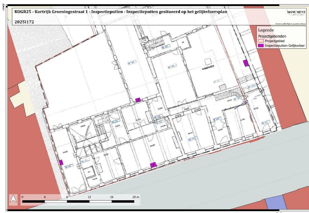
Figuur 15: Inspectieputten gesitueerd op het gelijksvloer (bijlage 4).
