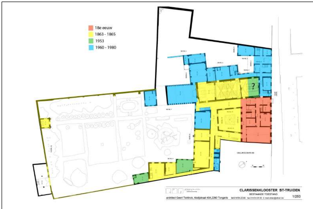
Afb. 24: Opmetingsplan van het gelijkvloers met aanduiding van de verschillende bouwfases (Fexer 2020 Afb. 26; digitaal plan, datum onbekend, 2024B295).
