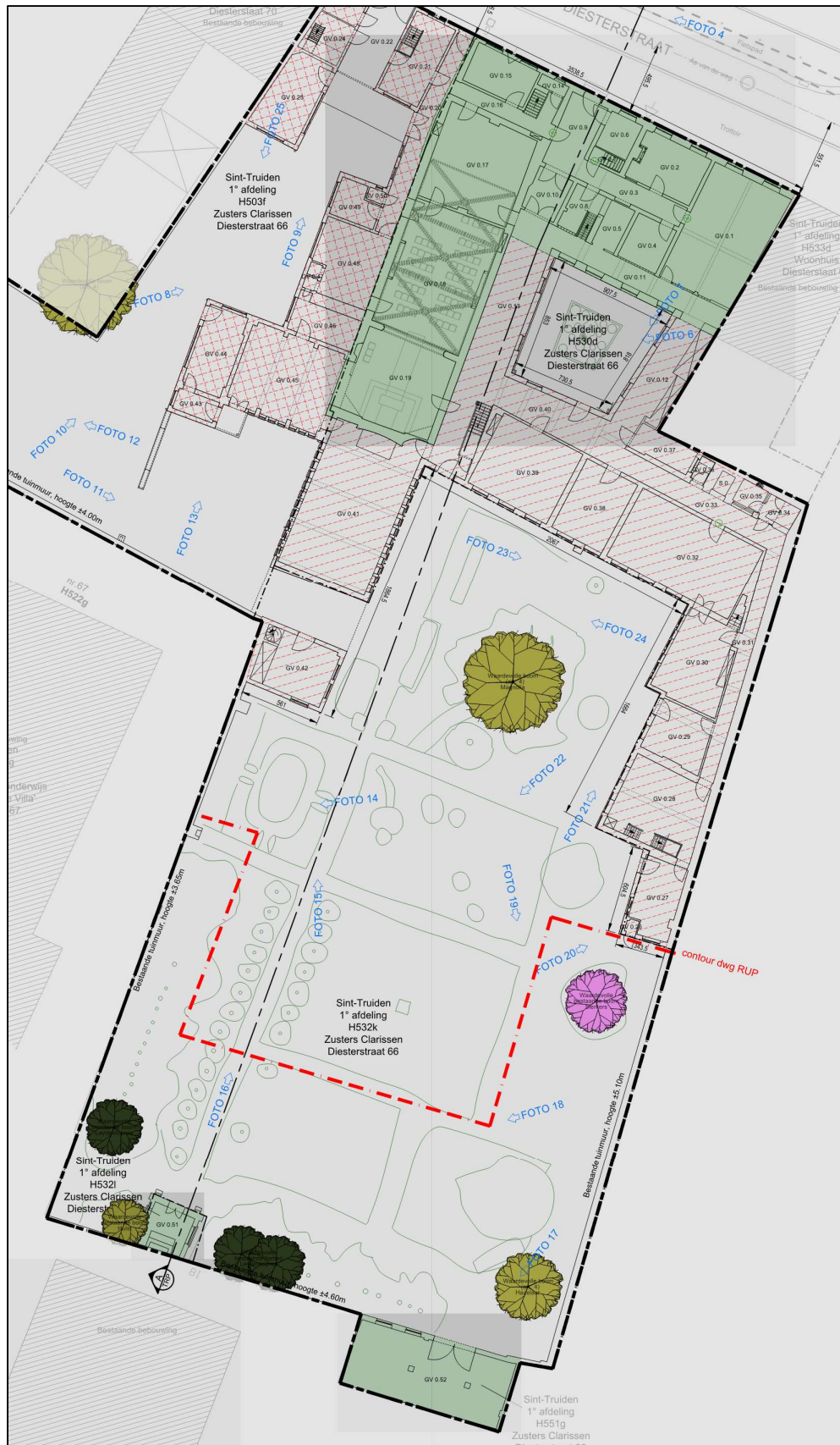
Afb. 3: Inplantingsplan bestaande toestand met aanduiding van de te behouden bebouwing in het groen en met aanduiding in kleur van de te behouden bomen. De te slopen bebouwing is in het rood gearceerd. De geblokte arcering behoort tot een eerdere omgevingsvergunning (perceel 503f) (Bron: opdrachtgever, digitaal plan, dd. 18/08/2021, aanmaatschaal onbekend, 2021141).
