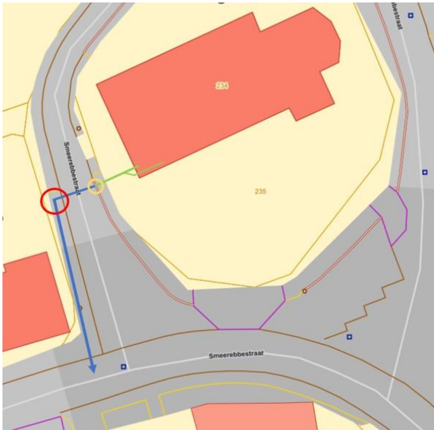
Figuur 4: De geplande werken voor de sanitaire ruimte binnen de Sint-Amanduskerk. De rioleringssleuf loopt vanuit het zuidwestportaal naar de Smeerebbestraat en wordt verderop aangesloten (bron: stad Geraardsbergen).
