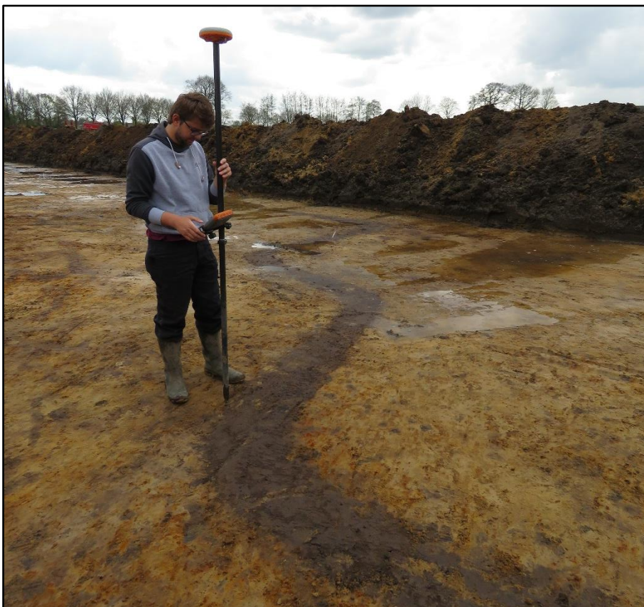
Figuur 17 Inmeten van de grondsporen met een GPS-toestel.
