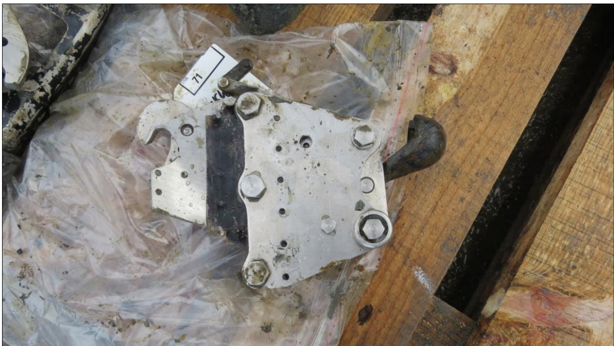
Fig. 44 Eén van de bomhaken in "open" toestand.
