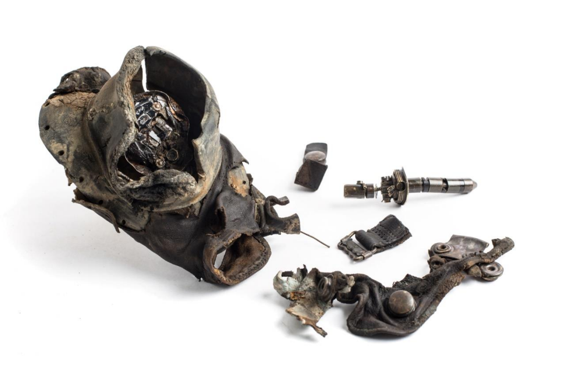
Fig. 64 Onderdelen vliegkap met hoofdtelefoon en fiche (rechtsboven) van de radio.
