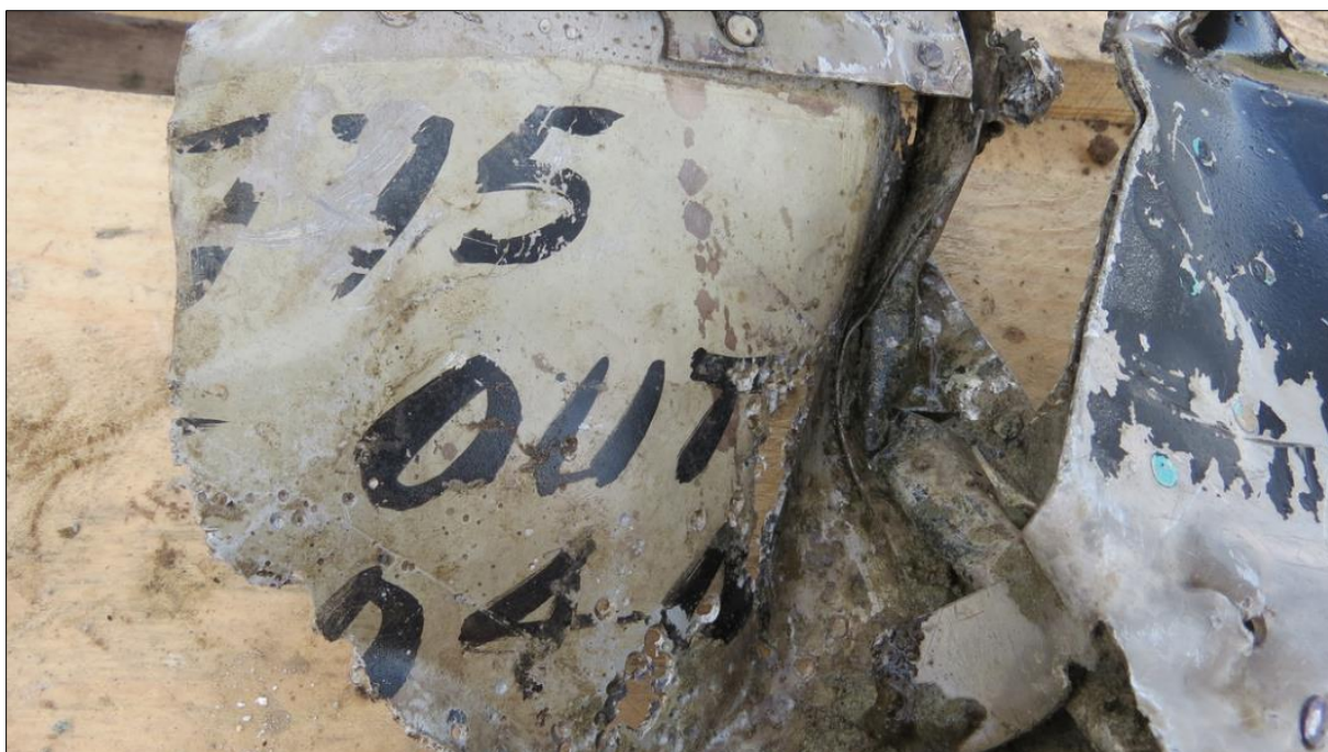
Fig. 38 De cijfers "775" zijn net te lezen - een verwijzing naar het serienummer van het vliegtuig.
