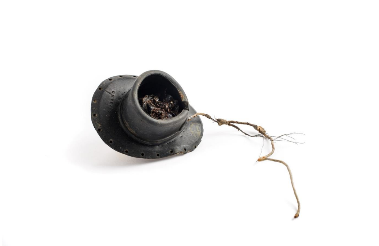
Fig. 52 Een deel van de hoofdtelefoon, nog gevat in de rubberen ring die aan de vliegkap vastzat.
