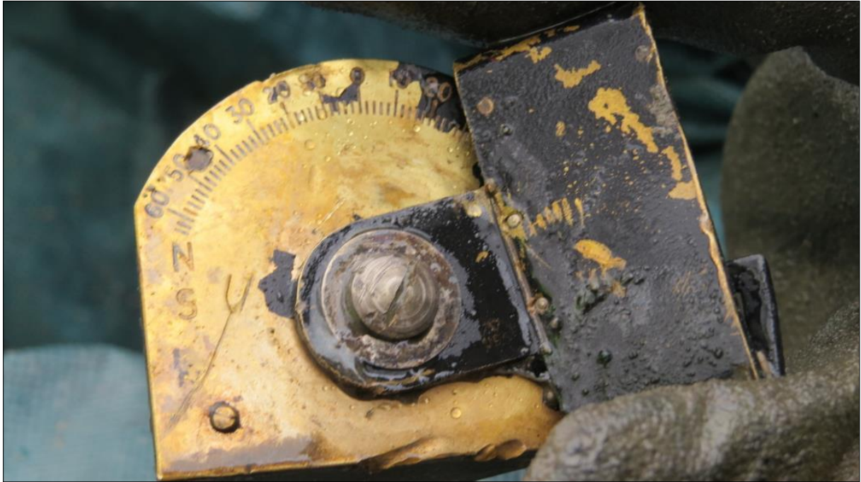
Fig. 49 Onderdeel van astrokompas, een toestel om het noorden te bepalen aan de hand van hemellichamen.
