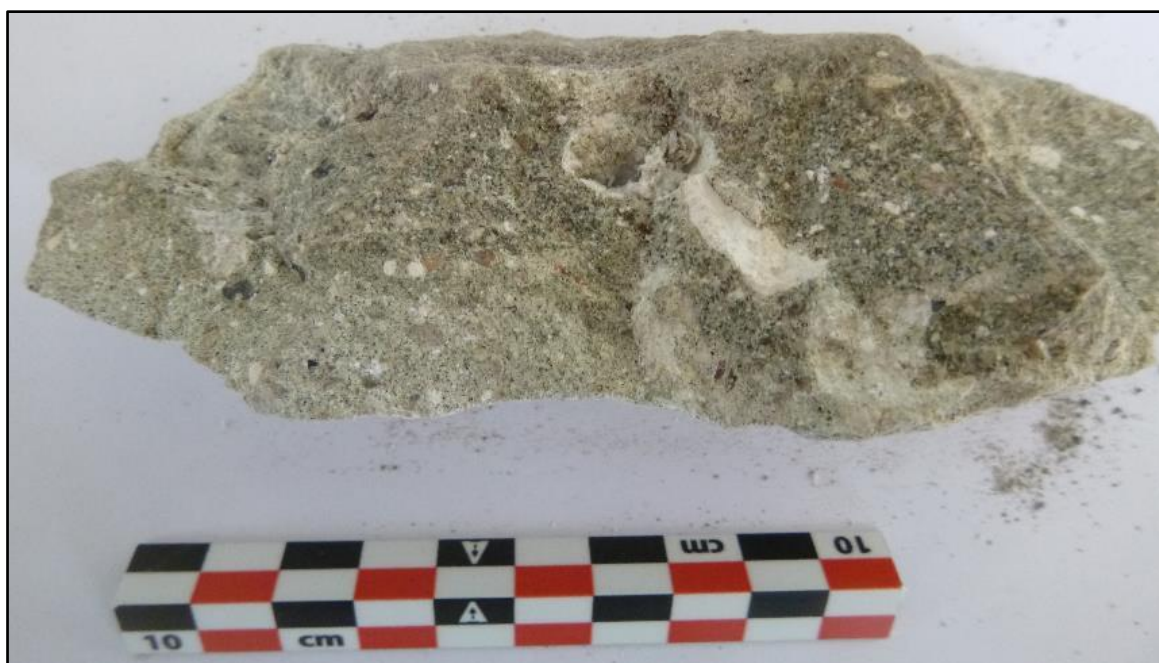
Figuur 18: Fotografische opname van een mortelstaal uit de dokmuur (ABO nv 2018)
