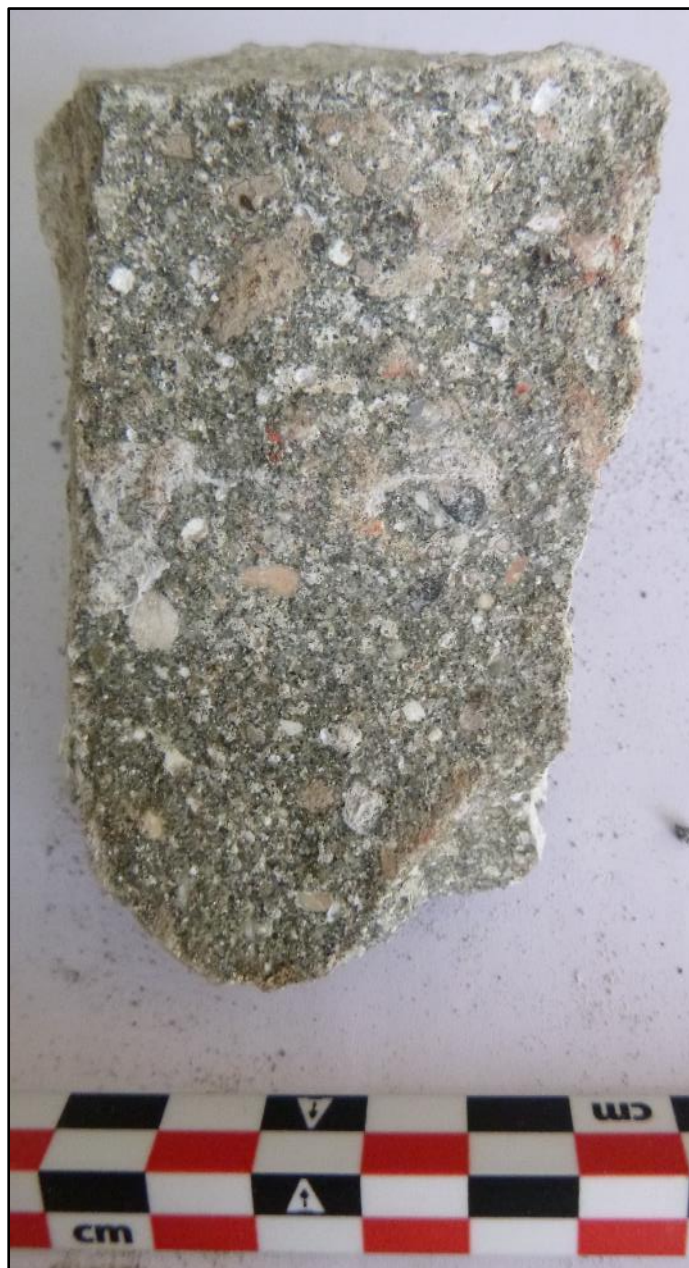
Figuur 19: Fotografische opname van een mortelstaal uit de dokmuur met gemalen steengruis (ABO nv 2018)
