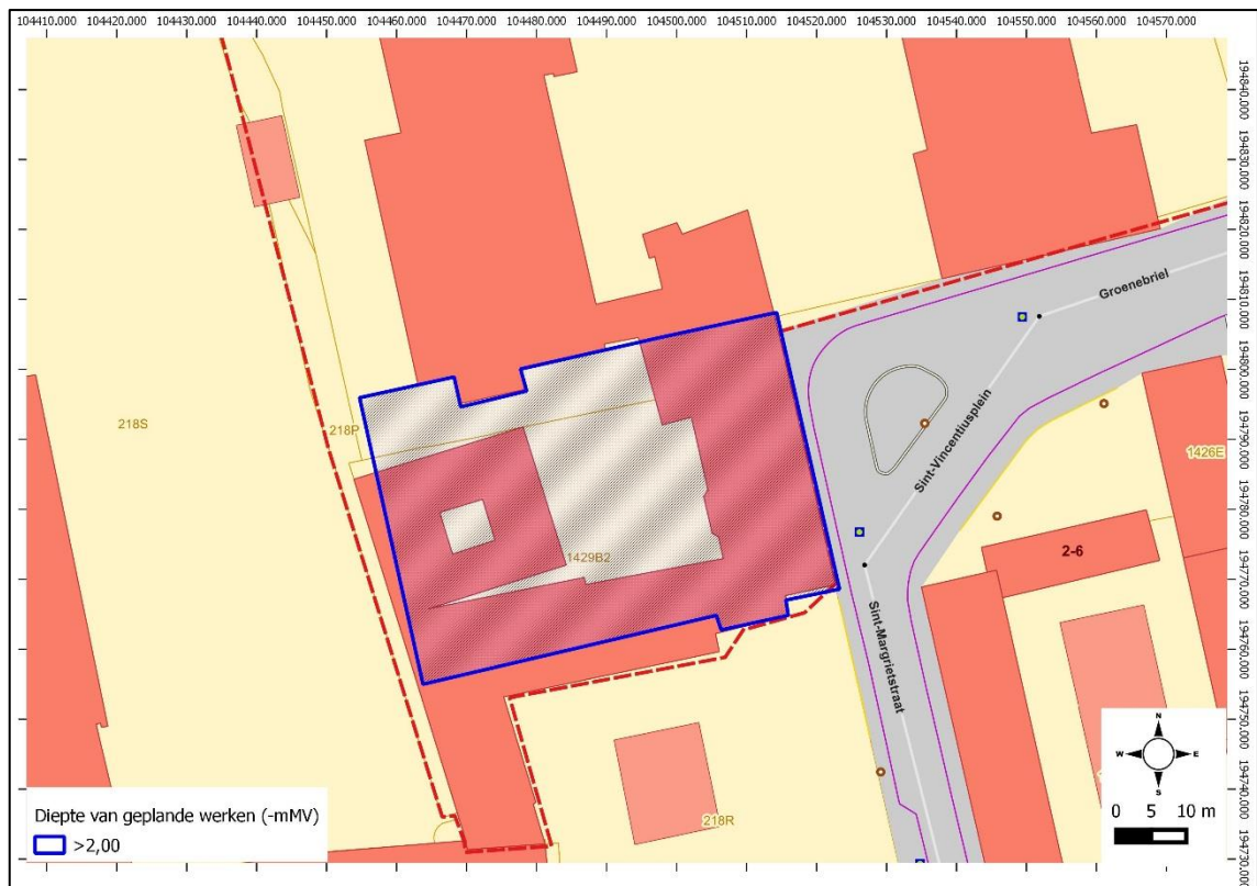
Figuur 11: diepte van verstoring nieuwbouw blok C (bron: ABO NV)
