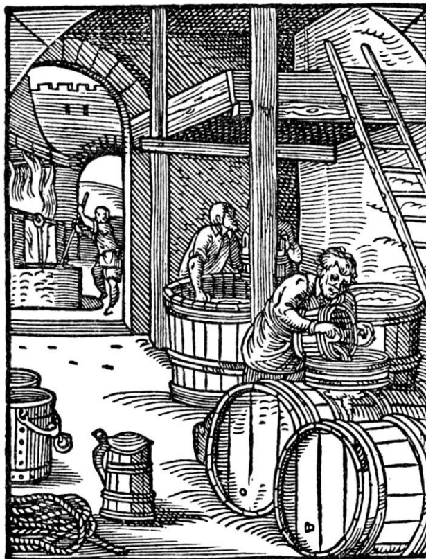
Figuur 20: Houtsnede uit 1568, met afbeelding van 'Der Bierbreuwer' door Jost Amman 14 met achteraan link de 'Brewkessel', centraal de 'Brennten' om de wort te laten koelen, en vooraan de houten vaten, 'Faß', om het bier te laten gisten.
