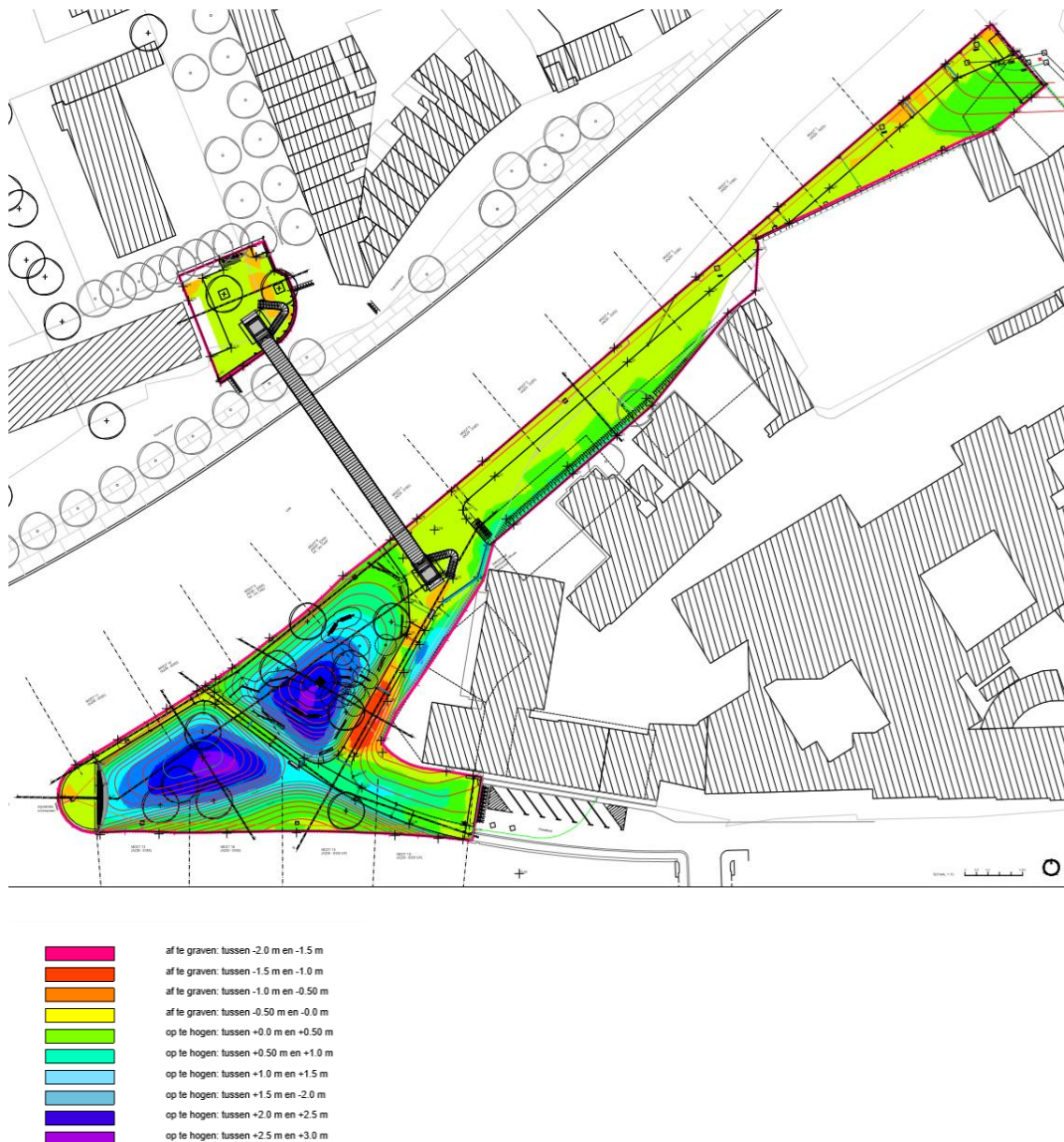
Figuur 6: Aanduiding zones van grondverzet binnen het projectgebied met aanduiding van hoogtelijnen en meetpunten in de zuidwestelijke hoek. De roze, rode, oranje en gele zones betreffen afgravingen variërend tussen -2 en -0 m; de groene, blauwgroene, blauwe en paarse zones betreffen ophogingen variërend tussen +0 en +3m. (bron: initiatiefnemer en Verslag van resultaten bureauonderzoek Kortrijk Reepbrug).
