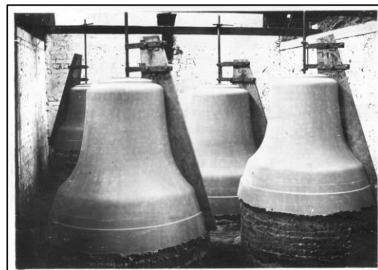
Figuur 59: Constructie van de binnenmal of kern aan de hand van het binnensjabloon en een voltooide binnenmal 70
