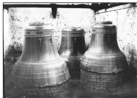
Figuur 60: Productie van de valse klok aan de hand van het buitensjabloon en een voltooide valse klok 71
