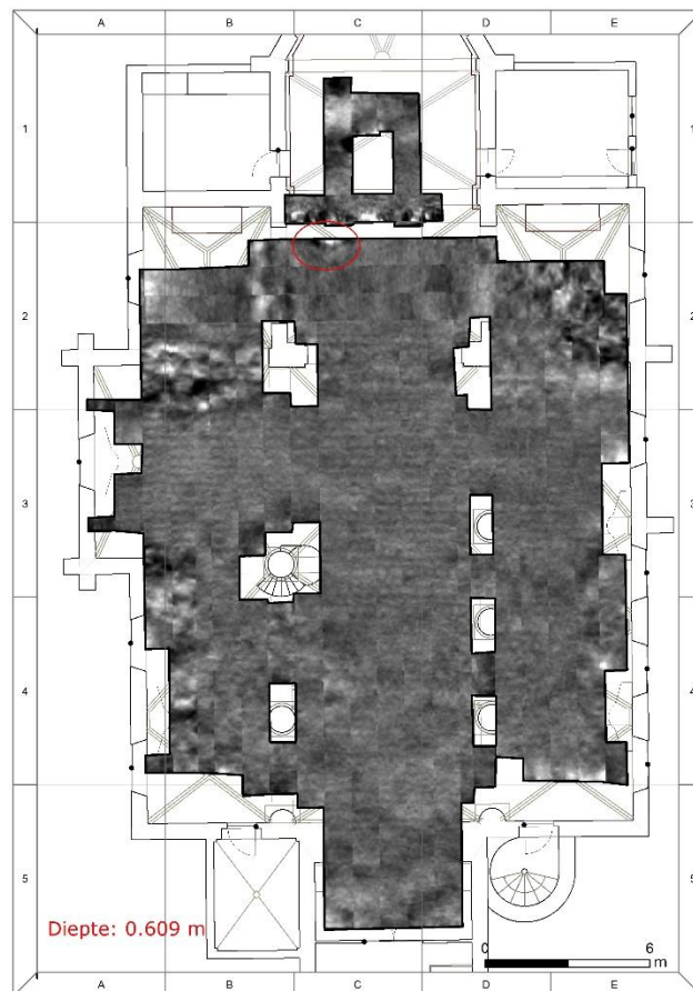
Figuur 12: Horizontale GPR doorsnede op 0.609 m diepte met aanduiding van een afwijkende zone of object.
