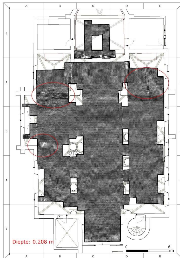
Figuur 8: Horizontale GPR doorsnede op 0.208 m diepte met aanduiding van afwijkende zones.
