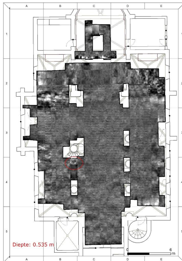
Figuur 13: Horizontale GPR doorsnede op 0.535 m diepte met aanduiding van een afwijkende zone.
