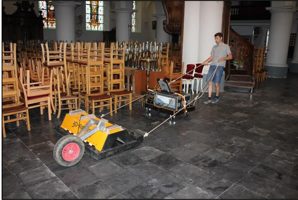
Figuur 2: De GPR meetconfiguratie in werking in de kerk van Moorsel.
