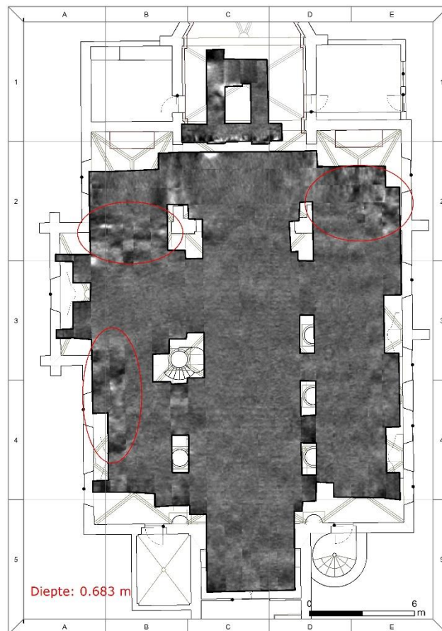
Figuur 10: Horizontale GPR doorsnede op 0.683 m diepte met aanduiding van afwijkende zones.
